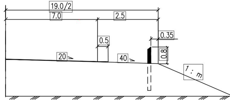
Примечание: \* - при установке знака в населенном пункте высота установки равна 2.0 - 4.0м
