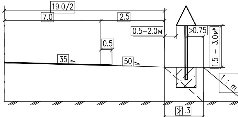
Примечание: \* - при установке знака в населенном пункте высота установки равна 2.0 - 4.0м
