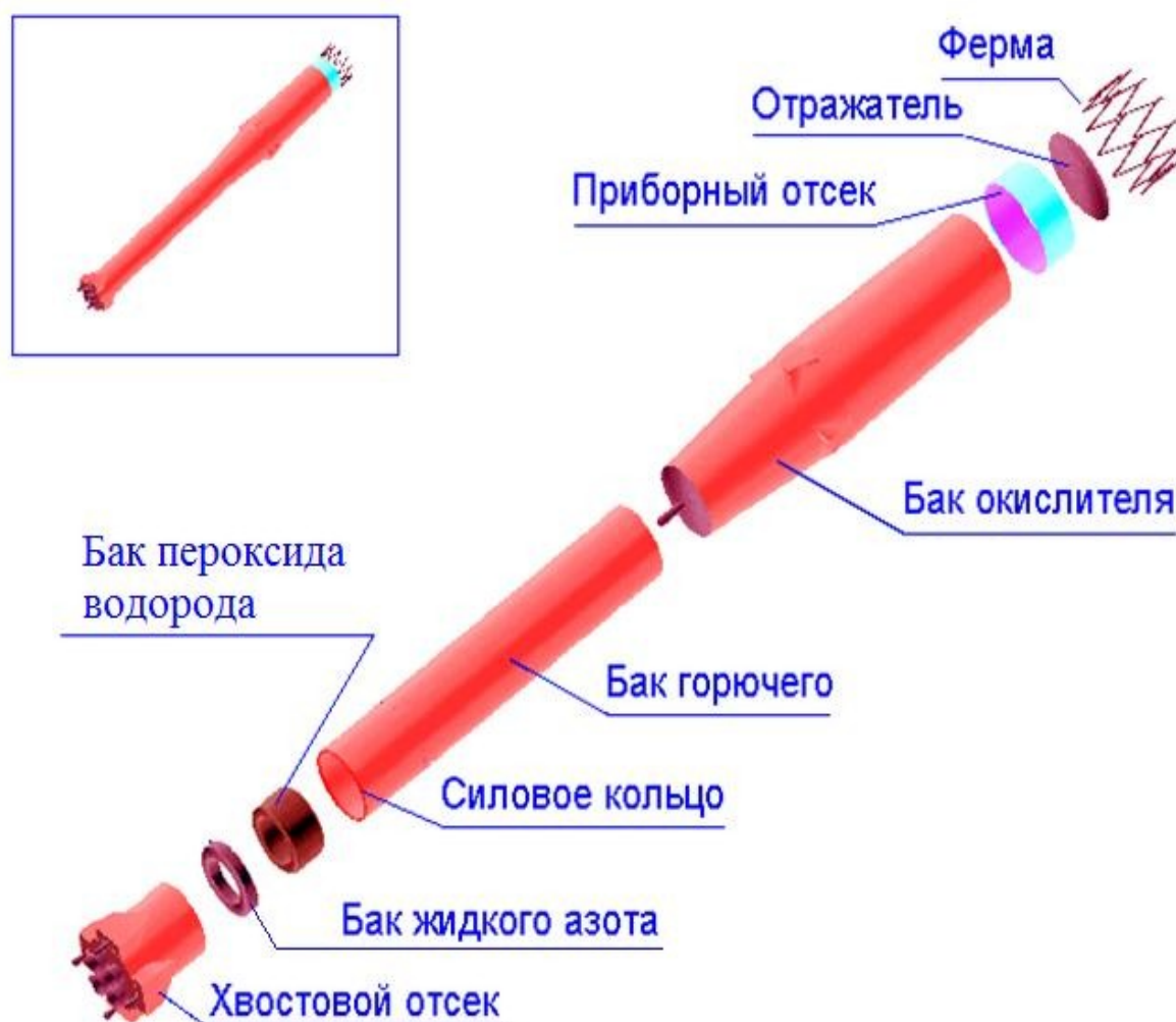
Рисунок 5. – Конструкция ЦБ РН «Союз-2»
