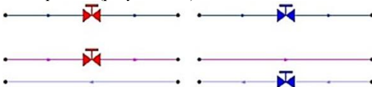
Рисунок 3.24 - Однолинейное изображение (слева) и внутреннее представление (справа) сети с регуляторами давления
