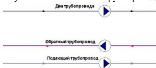
Рисунок 3.16 - Однолинейное изображение (вверху) и внутреннее представление (внизу) сети с насосными станциями
