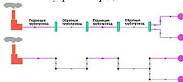
Рисунок 3.21 - Однолинейное изображение (вверху) и внутреннее представление (внизу) сети для летнего режима работы открытых систем централизованного теплоснабжения
